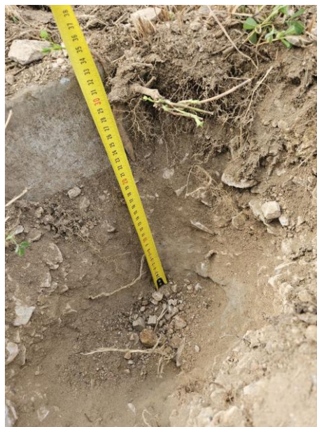
Zdj. 6 – istniejąca nawierzchnia – odkrywka
