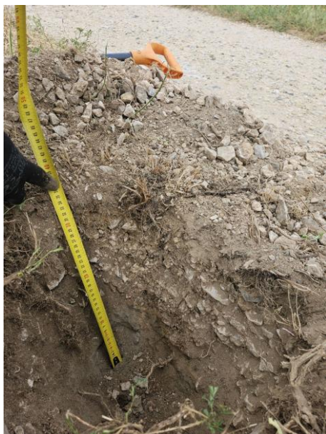
Zdj. 5 – istniejąca nawierzchnia – odkrywka
